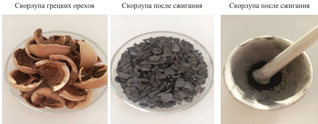
Рис. Получение адсорбента из скорлупы грецких орехов Fig. Obtaining an adsorbent from walnut shells
